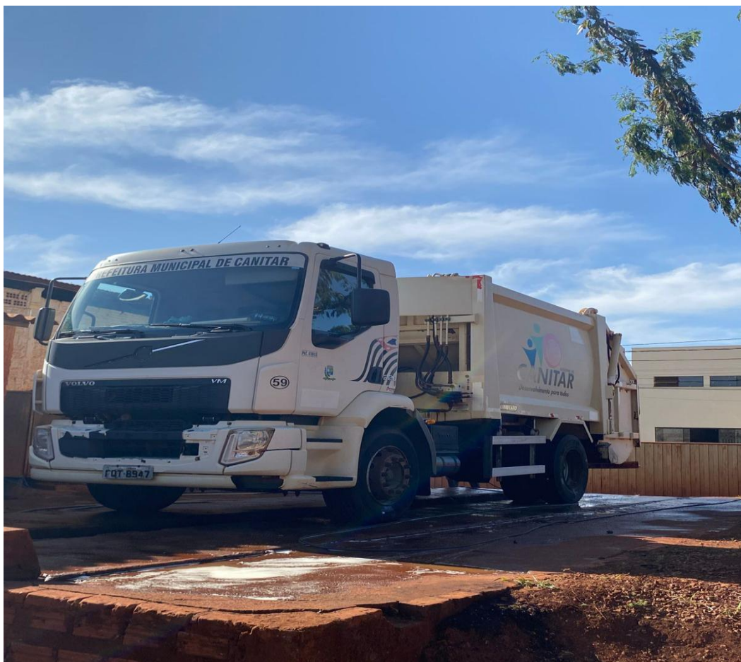
Figura 1 - Caminhão compactador VOLVO 220 – ANO 2014 Modelo 2015 utilizado na coleta do resíduo domiciliar.
